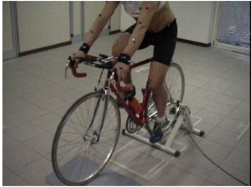
Soggetto con marcatori per analisi optoelettronica della pedalata, rappresentazione virtuale 3D del movimento (il triangolo rappresenta la bicicletta)
